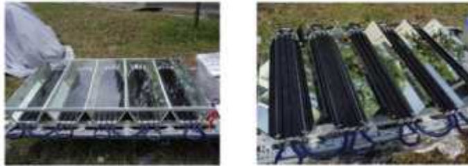
Gambar 3. Kolektor dengan pelat absorber dengan reflektor bentuk-V
